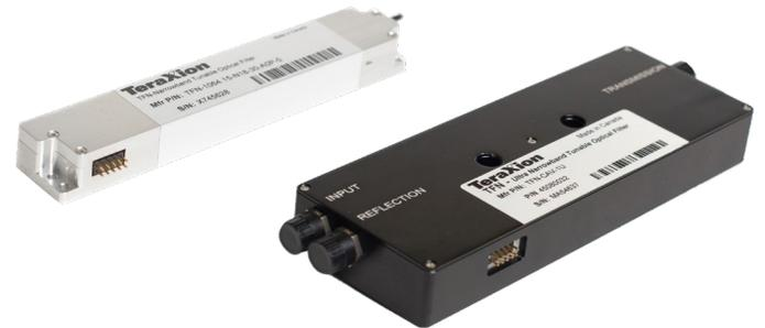
**Le filtre optique accordable à bande étroite TFN combine la technologie de réseaux de Bragg sur fibre de TeraXion et une plateforme ajustable thermiquement pour offrir une stabilité et une précision sans précédent.** Elle est offerte en deux modèles compacts et fiables : réflexion (R) et transmission-réflexion (T-R). L'option à bande étroite traite des bandes passantes de 2 GHz à 35 GHz, et l'option à bande ultra étroite, des bandes passantes de 50 MHz à 500 MHz.
