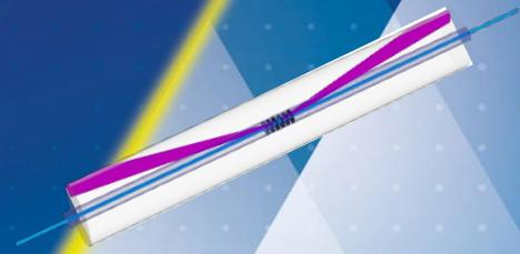
**L'ASE Shield est un filtre basé sur un réseau de Bragg à fibres (FBG) qui élimine le signal d'émission spontanée amplifiée (ASE) à la source.**
