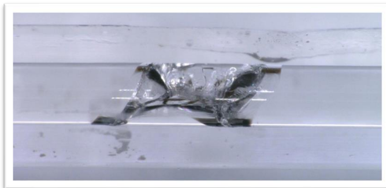
Figure 2. Un échauffement excessif peut endommager les FBG via l'effet « fiber fuse ».
